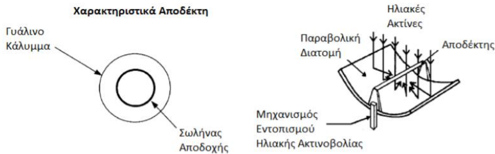
Εικόνα 5.7 Σχηματική απεικόνιση παραβολικού συλλέκτη [3]
