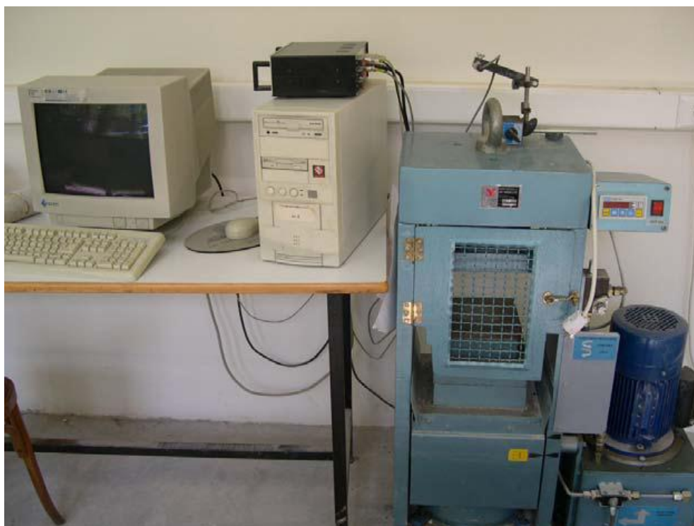
Εικόνα 15: Συσκευή (πρέσα) εκτέλεσης δοκιμής προσδιορισμού UCS
