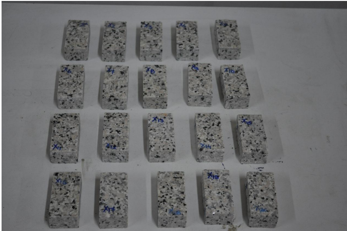
Εικόνα 23: Δοκίμια X1 – X20 (Rosa Beta) πριν τη θραύση με τη δοκιμή σημειακής φόρτισης
