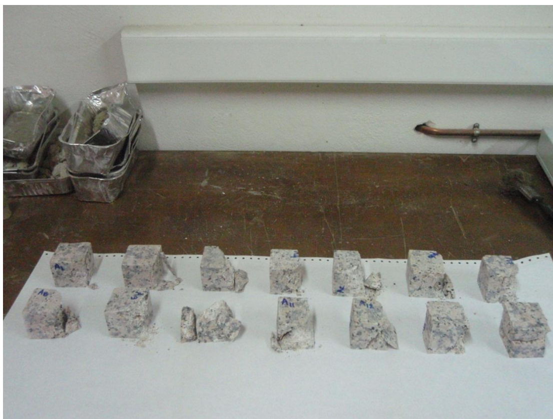
Εικόνα 28: Δοκίμια A1 – A14 (Rosa Porino) μετά τη θραύση με τη δοκιμή ανεμπόδιστης θλίψης
