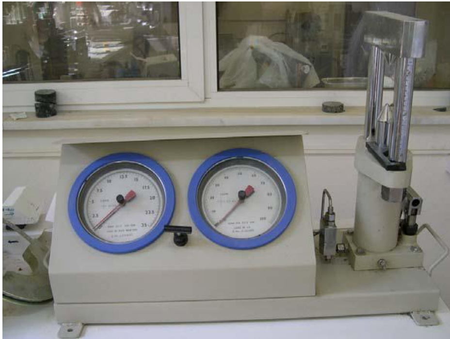
Εικόνα 16: Συσκευή εκτέλεσης δοκιμής PLT
