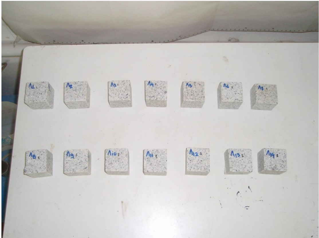
Εικόνα 25: Δοκίμια Λ1 – Λ14 (Bianco Crystal) πριν τη θραύση με τη δοκιμή ανεμπόδιστης θλίψης
