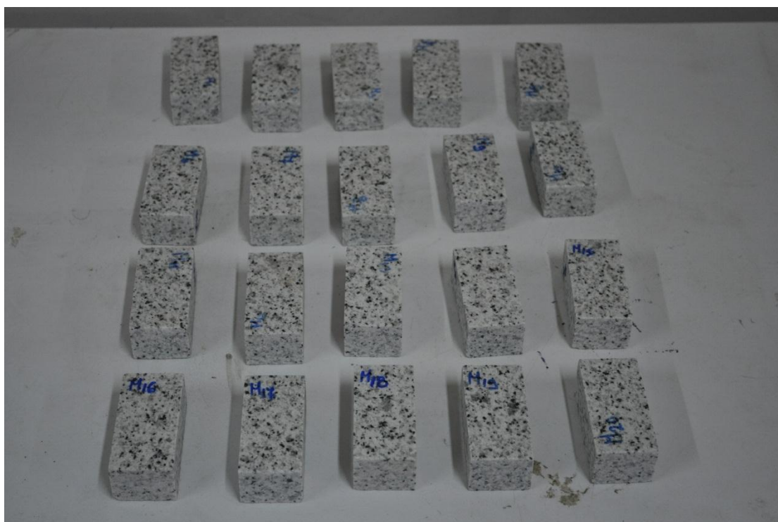
Εικόνα 21: Δοκίμια M1 – M20 (Bianco Real) πριν τη θραύση με τη δοκιμή σημειακής φόρτισης
