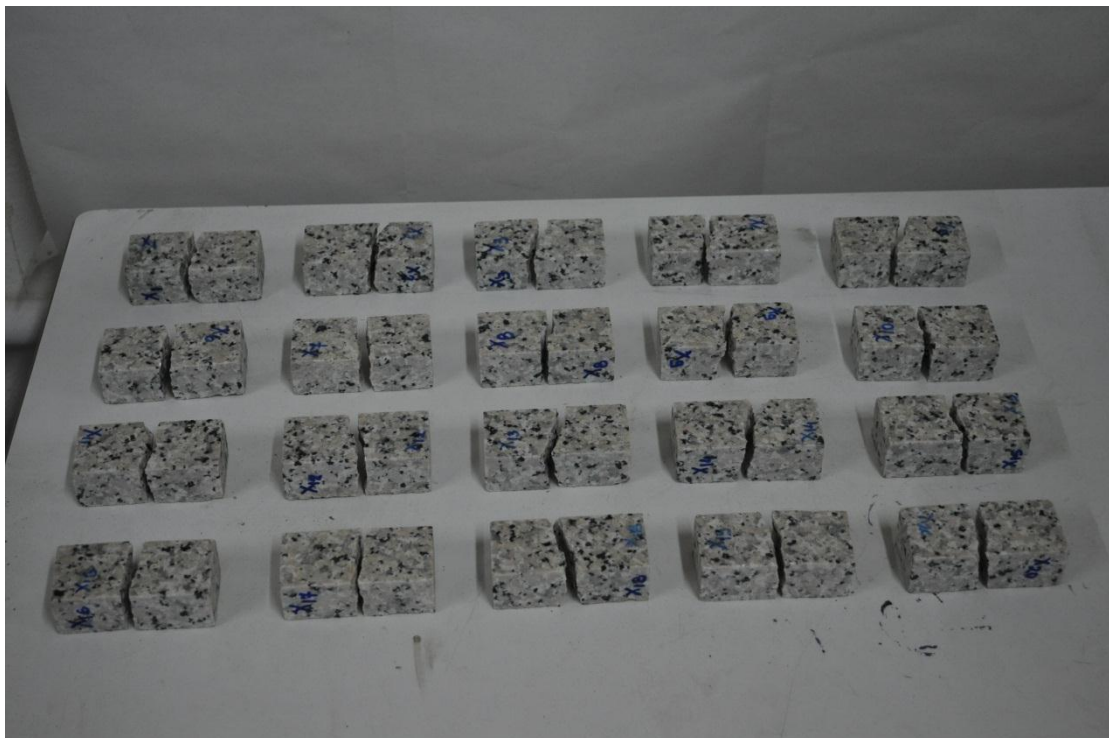
Εικόνα 24: Δοκίμια X1 – X20 (Rosa Beta) μετά τη θραύση με τη δοκιμή σημειακής φόρτισης
