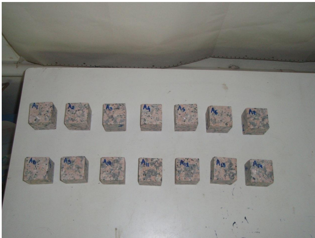
Εικόνα 27: Δοκίμια A1 – A14 (Rosa Porino) πριν τη θραύση με τη δοκιμή ανεμπόδιστης θλίψης
