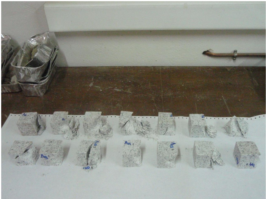
Εικόνα 26: Δοκίμια Λ1 – Λ14 (Bianco Crystal) μετά τη θραύση με τη δοκιμή ανεμπόδιστης θλίψης
