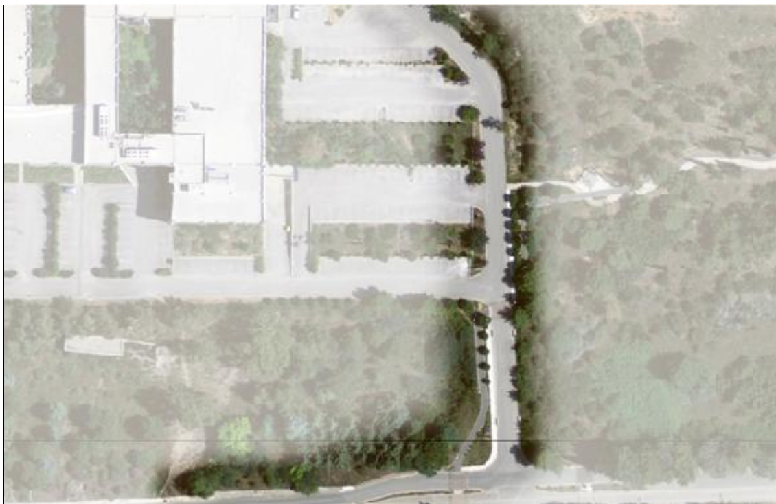
Εικόνα 5.11 Διαδρομή από στάση 240 προς Σχολές. Διακρίνεται διαδοχή πεζοδρομίου από την μία πλευρά του δρόμου στην απέναντι αλλά και πλήρης απουσία πεζοδρομίου στο τμήμα με τις νησίδες του χώρου στάθμευσης
