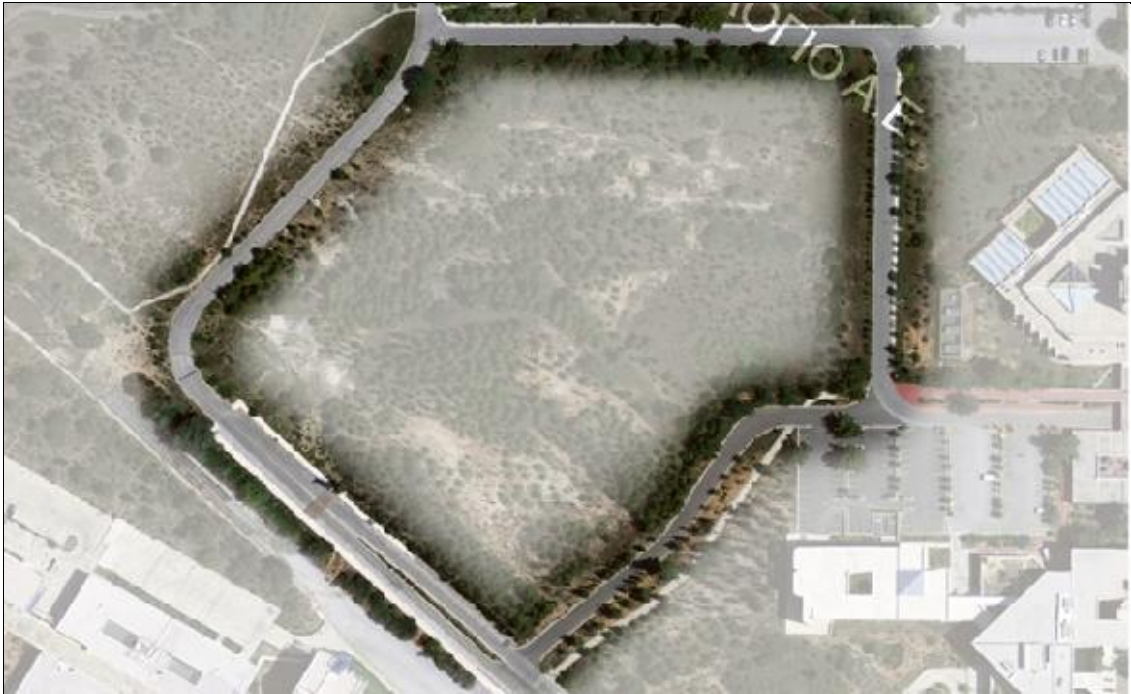
Εικ. 5.50 Βρόγχος εντός του περιμετρικού δακτυλίου που εξυπηρετεί σε μικρό βαθμό την κίνηση οχημάτων, δημιουργεί προβλήματα καθοδήγησης και διασπά όμοιες περιοχές πρασίνου
