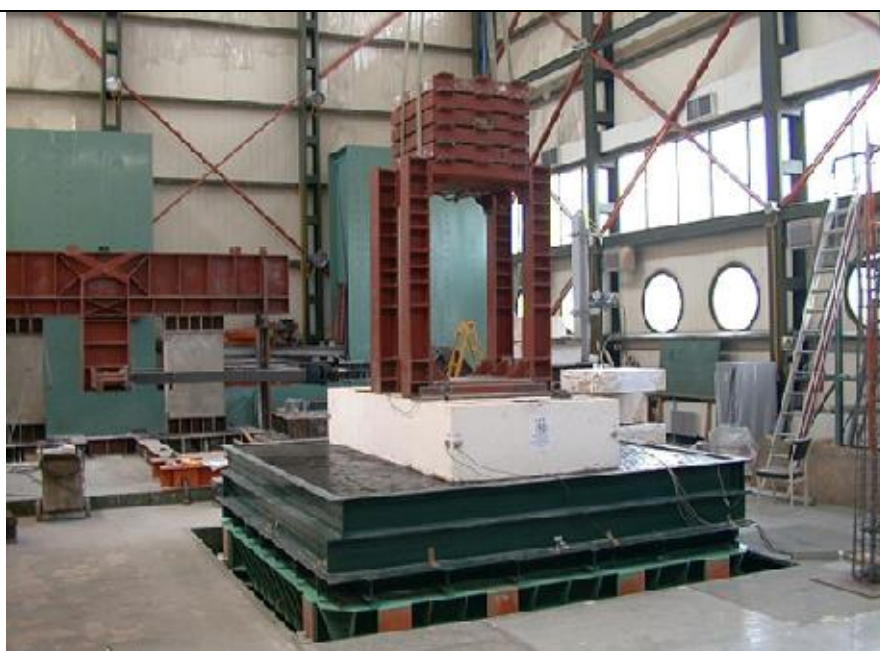
Εικόνα 3.1. Χώρος εργαστηρίου στο Κτίριο Αντισεισμικής Τεχνολογίας με ειδικό εξοπλισμό για τον έλεγχο αντισεισμικής αντοχής δομικών υλικών και κατασκευών.
