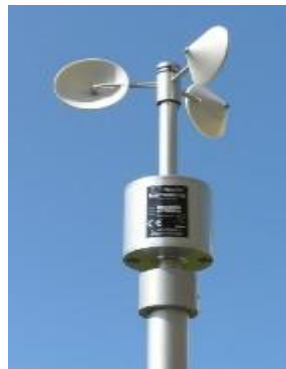
Εικόνα 6.4.1: Ανεμόμετρο κυπέλων (τύπου A100L2)
