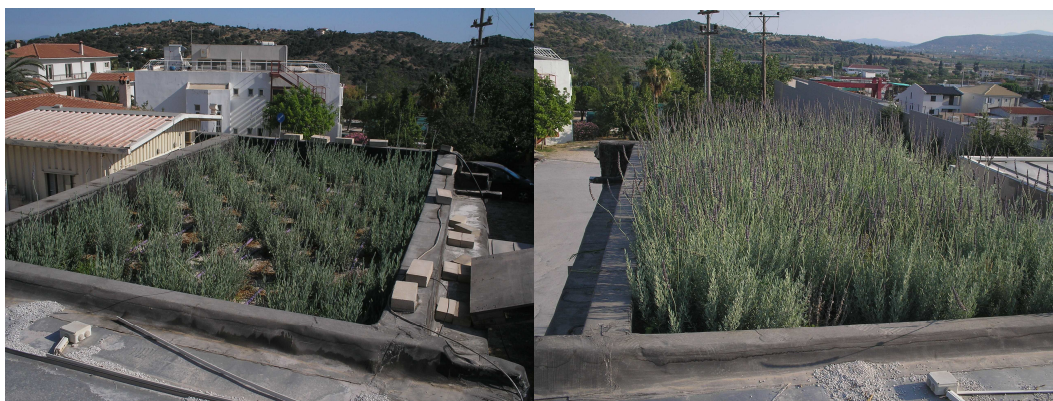
Εικόνα 7.5. Εγκατάσταση δοκιμίου φυτεμένου δώματος επί της οροφής του Θαλάμου δοκιμών στο ΚΑΠΕ, με υπόστρωμα βάθους 20 cm και φύτευση με Lavandula angustifolia .
