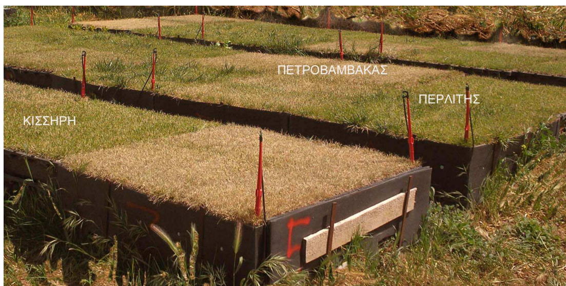
Εικόνα 5.1. Οπτική ποιότητα του χλοοτάπητα στα διάφορα πειραματικά τεμάχια μετά από πενήμερη διακοπή της άρδευσης. Διακρίνονται: πετροβάμβακας, P_{um65}:P_{30}:Z_5 (με κίσσηρη) και S_{30}:Per_{65}:Z_5 (με περλίτη). Τα πιο έντονα κίτρινα έως αποξηραμένα πειραματικά τεμάχια, είναι αυτά με υπόστρωμα πετροβάμβακα.
