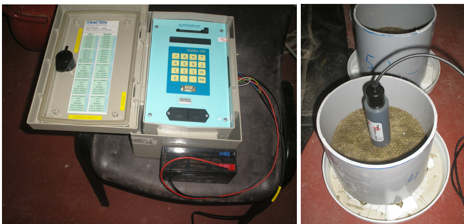
Εικόνα Π7. Στάθμιση αισθητήρα για τη μέτρηση υγρασίας στον πετροβάμβακα. Μετρήθηκε η τάση - με την βοήθεια καταγραφικού Stylitis-100 και των αισθητήρων Theta probe ML2X και η πραγματική περιεχομένη υγρασία, με ζυγίσεις προ και μετά την ξήρανση.
