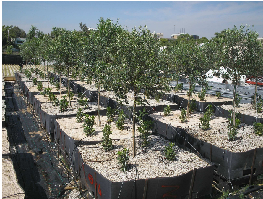
Εικόνα 2.2. Πειραματικά τεμάχια εντατικού φυτοδώματος με συνδυασμένη φύτευση από Pittosporum tobira και Olea europaea 'Koroneiki'.
