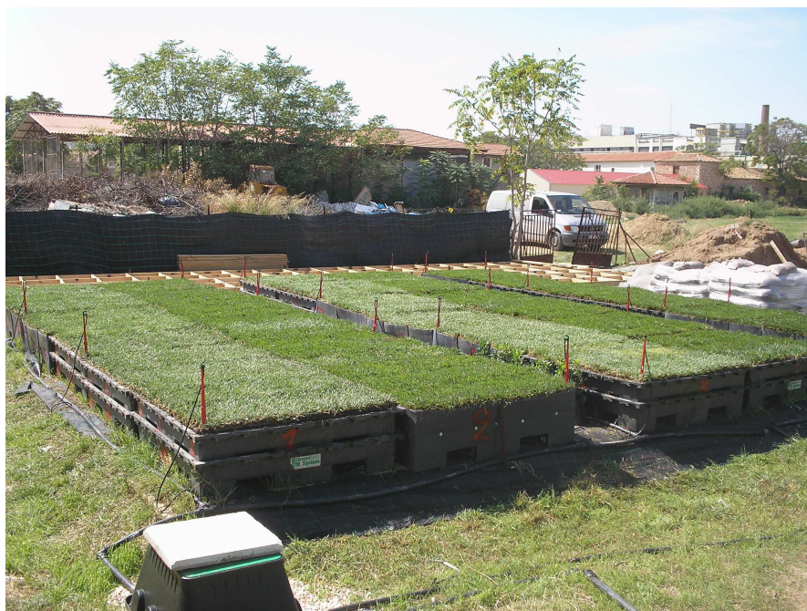
Εικόνα 2.4. Πειραματικά τεμάχια ημιεντατικού φυτοδώματος με εδαφοκάλυψη από Festuca arundinacea .
