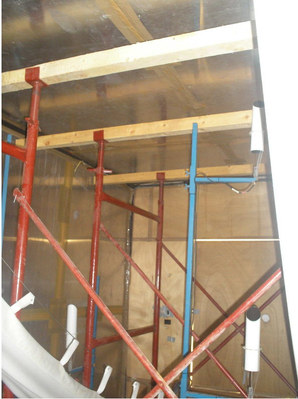
Εικόνα Π.8. Σε διαφορετικά ύψη επί ορθοστατών, τοποθετήθηκαν κεκαλυμμένοι οι αισθητήρες θερμοκρασίας αέρα του θαλάμου ελέγχου.
