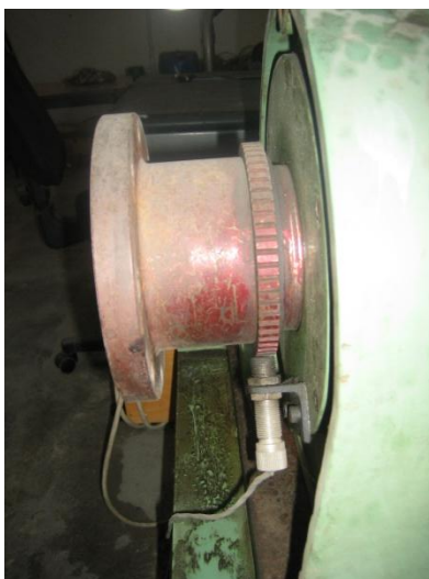
Εικόνα 4-7 Αισθητήρας εγγύτητας καταγραφής της ταχύτητας περιστροφής του κινητήρα
