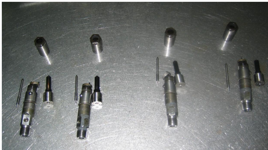
Εικόνα 10-5 Αποσυναρμολογημένοι εγχυτήρες μετά την δοκιμή 42 h
