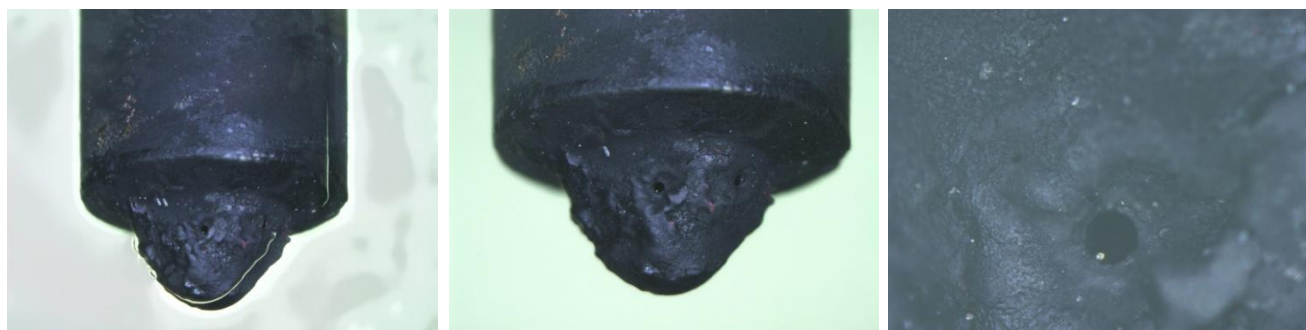
Εικόνα Ε-0-1 Ακροφύσιο του εγχυτήρα του κυλίνδρου Β σε τρεις μεγεθύνσεις μετά τη δοκιμή διάρκειας 42 h
