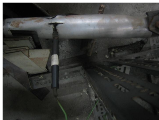
Εικόνα 4-27 Θερμοζεύγος μέτρησης θερμοκρασίας αέρα περιβάλλοντος (α) ανιχνευτής (probe) (β) τοποθετημένος ανιχνευτής στην οπή πρόσθεση λιπαντικού ελαίου
