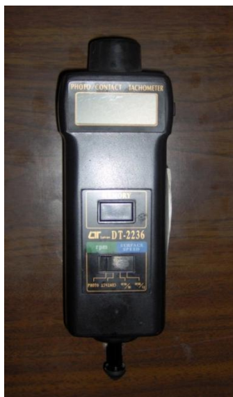
Εικόνα 4-8 Οπτικός μετρητής καταγραφής της ταχύτητας περιστροφής του κινητήρα
