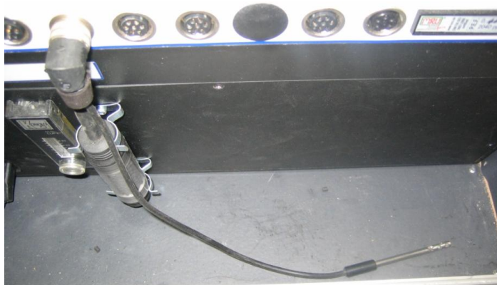
Εικόνα 4-27 Θερμοζεύγος μέτρησης θερμοκρασίας αέρα περιβάλλοντος (α) ανιχνευτής (probe) (β) τοποθετημένος ανιχνευτής στην οπή πρόσθεση λιπαντικού ελαίου
