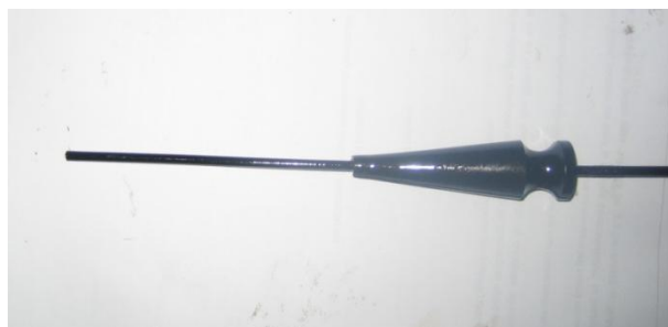
Εικόνα 4-29 Θερμοζεύγος μέτρησης θερμοκρασίας λιπαντικού ελαίου (α) ανιχνευτής (probe) (β) τοποθετημένος ανιχνευτής στην οπή πρόσθεση λιπαντικού ελαίου
