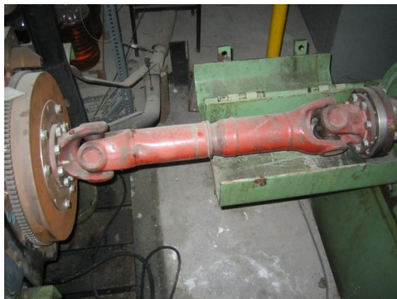
Εικόνα 4-11 Σταυροειδής άξονας σύνδεσης υδραυλικού δυναμομέτρου και κινητήρα
