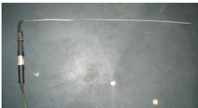
Εικόνα 4-28 Θερμοζεύγος μέτρησης θερμοκρασίας καυσαερίων (α) ανιχνευτής (probe) (β) τοποθετημένος ανιχνευτής στην εξάτμιση
