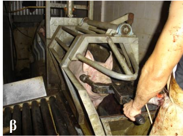
Εικόνες 3.1 α, β: Οδήγηση των χοίρων στο σημείο αναισθητοποίησης (α), εφαρμογή των ηλεκτροδίων στο κεφάλι του ζώου και διοχέτευση του ρεύματος (β).
