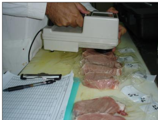
Εικόνα 2.3: Μέτρηση του χρώματος με χρωματόμετρο.
