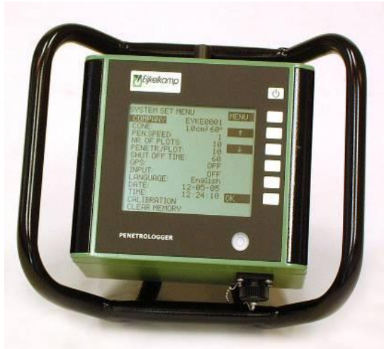
Εικόνα 4: Η κεφαλή του πενετρόμετρου που χρησιμοποιήσαμε
