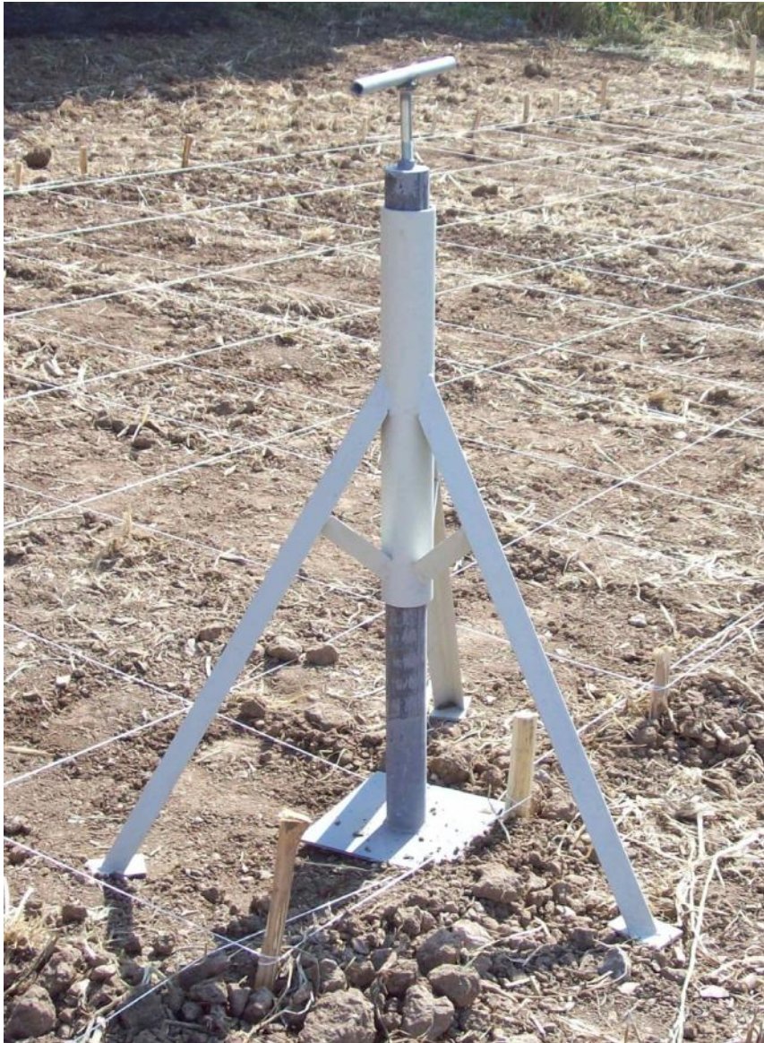
Εικόνα 1: Το χειροκίνητο μηχάνημα συμπίεσης με το οποίο πραγματοποιήθηκαν οι εδαφικές συμπιέσεις
