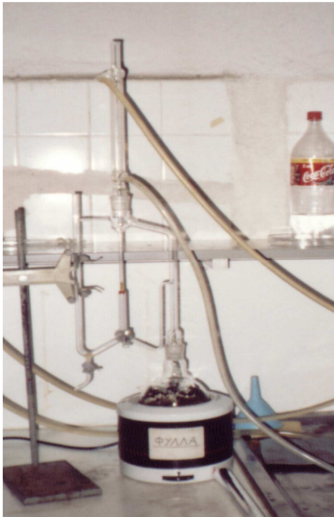
Εικόνα 16: απόσταξη φύλλων φυτών ρίγανης ( Origanum vulgare spp hirtum ), σε αποστακτική συσκευή τύπου Clevenger.
