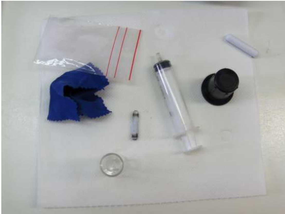
Εικόνα 20. Ειδικό φιαλίδιο θολόμετρου, η σύριγγα που χρησιμοποιήσαμε και το πανάκι καθαρισμού του φιαλιδίου.
