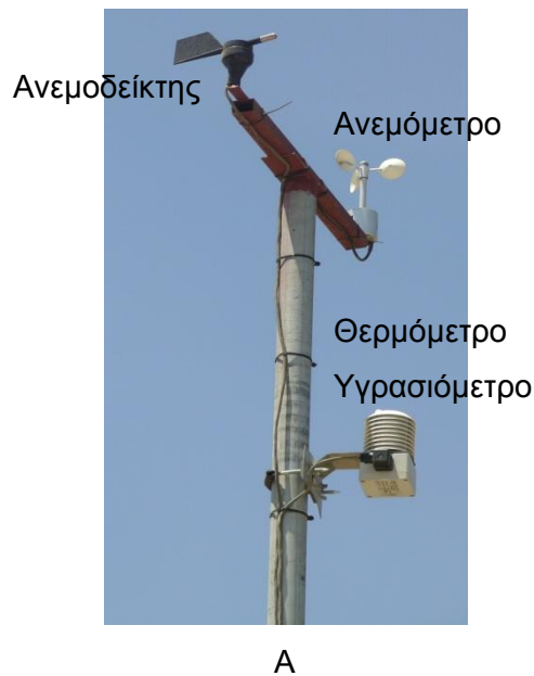
Εικόνα 3-32: Αισθητήρια για τη μέτρηση μετεωρολογικών μεγεθών (Α) – Πυρανόμετρο για μέτρηση της έντασης της ηλιακής ακτινοβολίας
