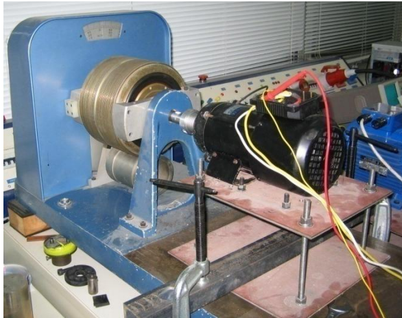
Εικόνα 3-35: Το ηλεκτρικό κινητήρα πάνω στη ηλεκτρομαγνητική πέδη
