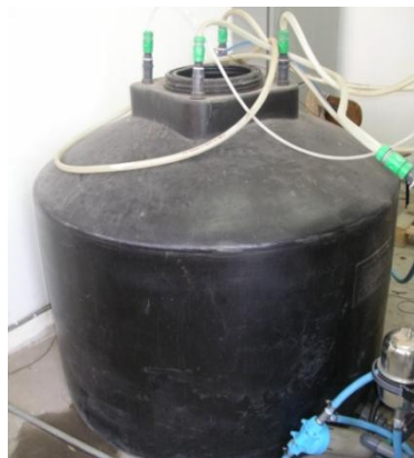
Εικόνα 3-6: Η δεξαμενή τροφοδοσίας
