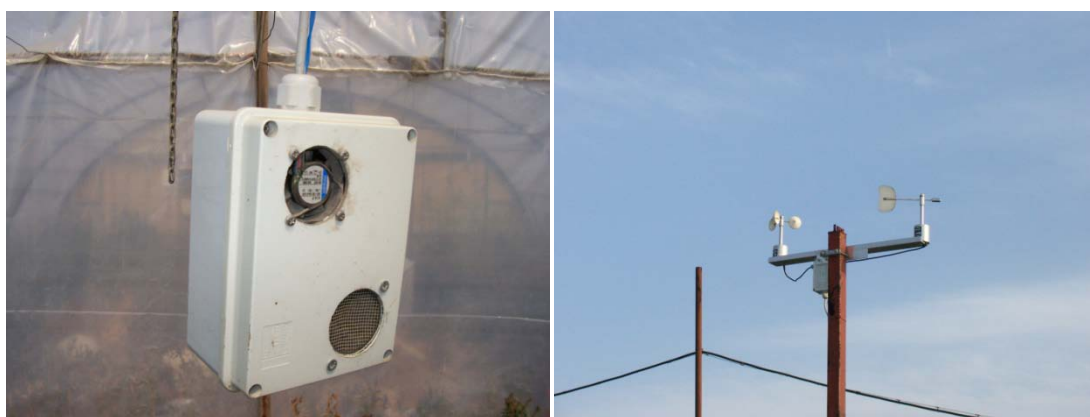
Εικόνα 3.2. Μέτρηση μετεωρολογικών παραμέτρων α) σε αεριζόμενο κλωβό μέσα στο θερμοκήπιο και β) σε ιστό έξω από το θερμοκήπιο.
