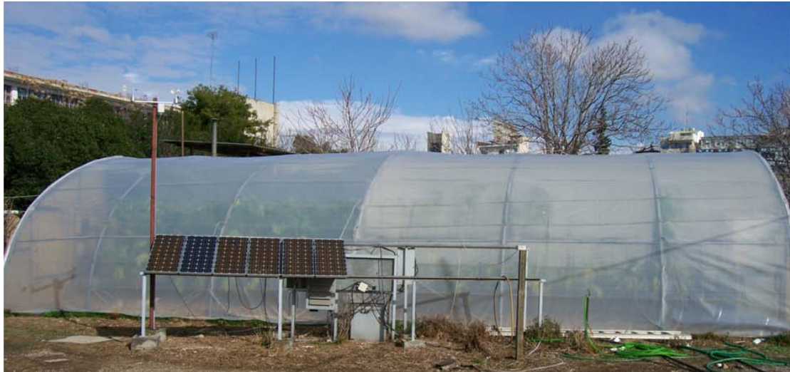
Εικόνα 5.1. Αριστερά το διαμέρισμα του θερμοκηπίου με αφύγρανση και δεξιά το διαμέρισμα του θερμοκηπίου χωρίς αφύγρανση.
