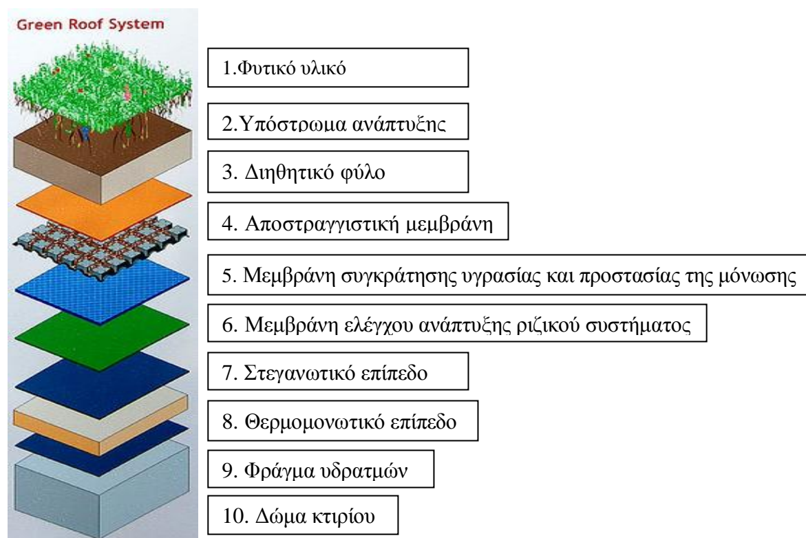
Εικόνα10. Επίπεδα φυτεμένου δώματος (Πηγή: http://www.nophadrain.nl )
