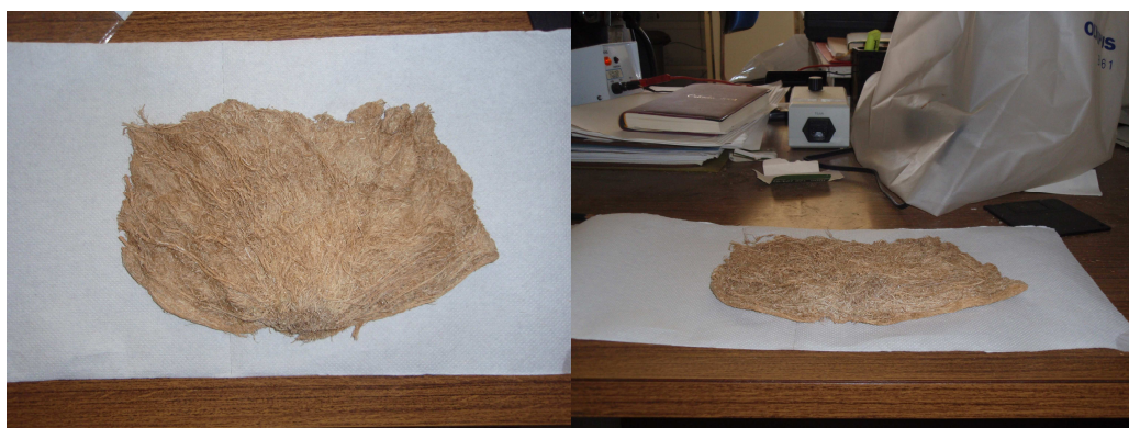
Εικόνα 36-37: Αποξηραμένο ριζικό σύστημα από το κανάλι NFT με διαχωρισμένη ρίζα (από το διαμέρισμα με επέμβαση SiO 2 )
