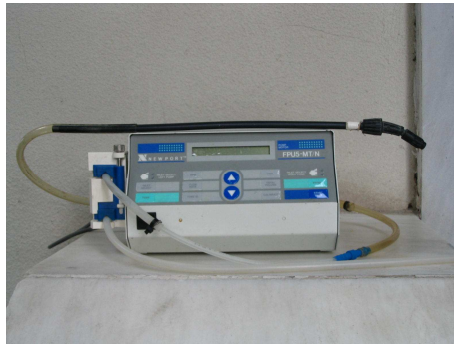
Εικόνα 10. Αντλία που χρησιμοποιήθηκε για την εφαρμογή της άρδευσης
