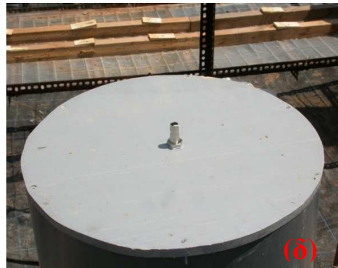
Εικόνα 5. Η διαδικασία τοποθέτησης του μεταλλικού σπειρώματος (α). Η δημιουργία ανοίγματος στο λυσίμετρο (β). Η τοποθέτηση στεγανοποιητικού υλικού στο σπείρωμα (γ). Το βίδωμα του σπειρώματος στην κάτω επιφάνεια του λυσιμέτρου (δ). Η τελική μορφή του κάτω μέρους του λυσιμέτρου Πηγή: Τσογγαράκης, 2005; Κοτοπούλης 2006
