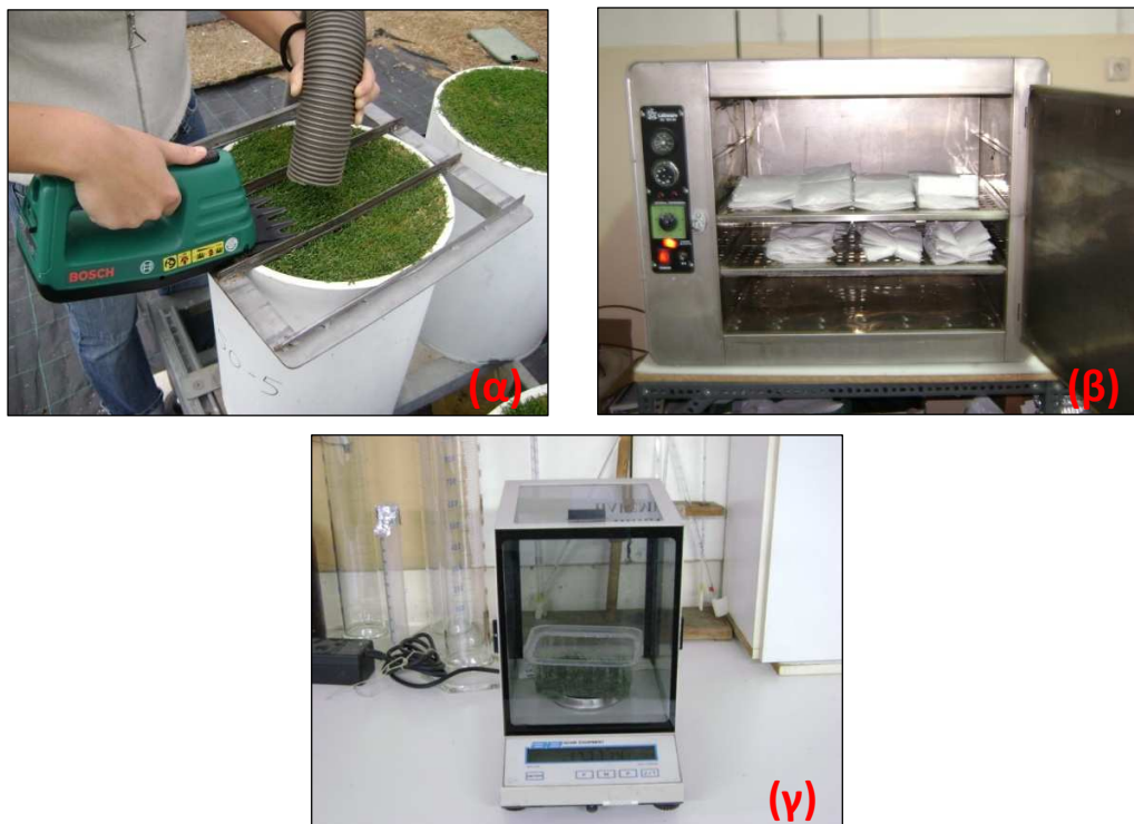
Εικόνα 11. (α). Διαδικασία κοπής χλοοτάπητα (β). Το ξηραντήριο που χρησιμοποιήθηκε (γ). Η ζυγαριά ακριβείας
