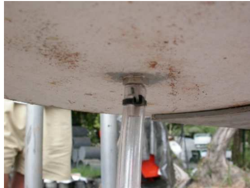
Εικόνα 6. Τοποθέτηση και σταθεροποίηση του εύκαμπτου, διάφανου σωλήνα στην άκρη των σπειρωμάτων. Πηγή: Τσογγαράκης, 2005; Κοτοπούλης 2006
