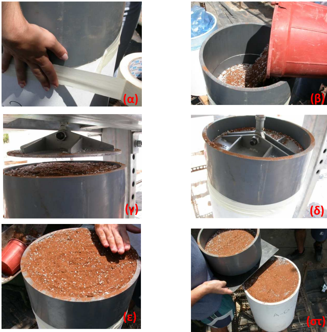
Εικόνα 9. Η διαδικασία πλήρωσης των λυσιμέτρων με τα υποστρώματα και η συμπίεση των υποστρωμάτων.
