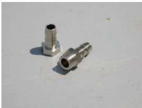
Εικόνα 4. Λεπτομέρεια των μεταλλικών σπειρωμάτων που χρησιμοποιήθηκαν για την κατασκευή των λυσιμέτρων. Πηγή: Τσογγαράκης, 2005; Κοτοπούλης 2006
