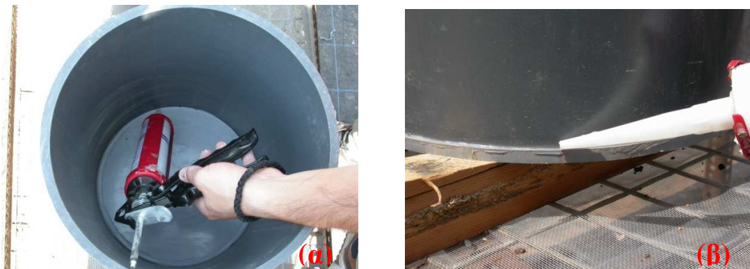
Εικόνα 3. Η διαδικασία τοποθέτησης ακρυλικής σιλικόνης, εσωτερικά (α) και εξωτερικά (β) του λυσίμετρου, για την αποφυγή διαρροών. Πηγή: Τσογγαράκης, 2005; Κοτοπούλης 2006.
