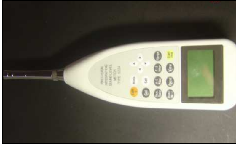
Εικόνα 9.24. Το ηχώμετρο που χρησιμοποιήθηκε για την διεξαγωγή των μετρήσεων (Πηγή: Αρμπής Γεώργιος)
