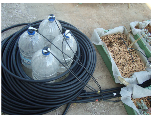
Εικόνα 24: Αυτοσχέδιο σύστημα ελέγχου της ποσότητας άρδευσης και της ομαλής λειτουργίας του αυτόματου συστήματος ποτίσματος.
