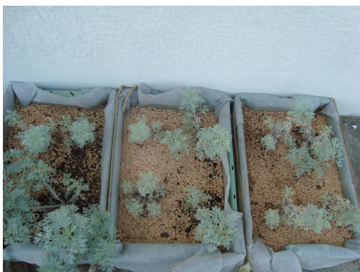
Εικόνα 32: Αρτεμισία σε τύρφη, μεγάλο βάθος υποστρώματος και συχνή άρδευση
