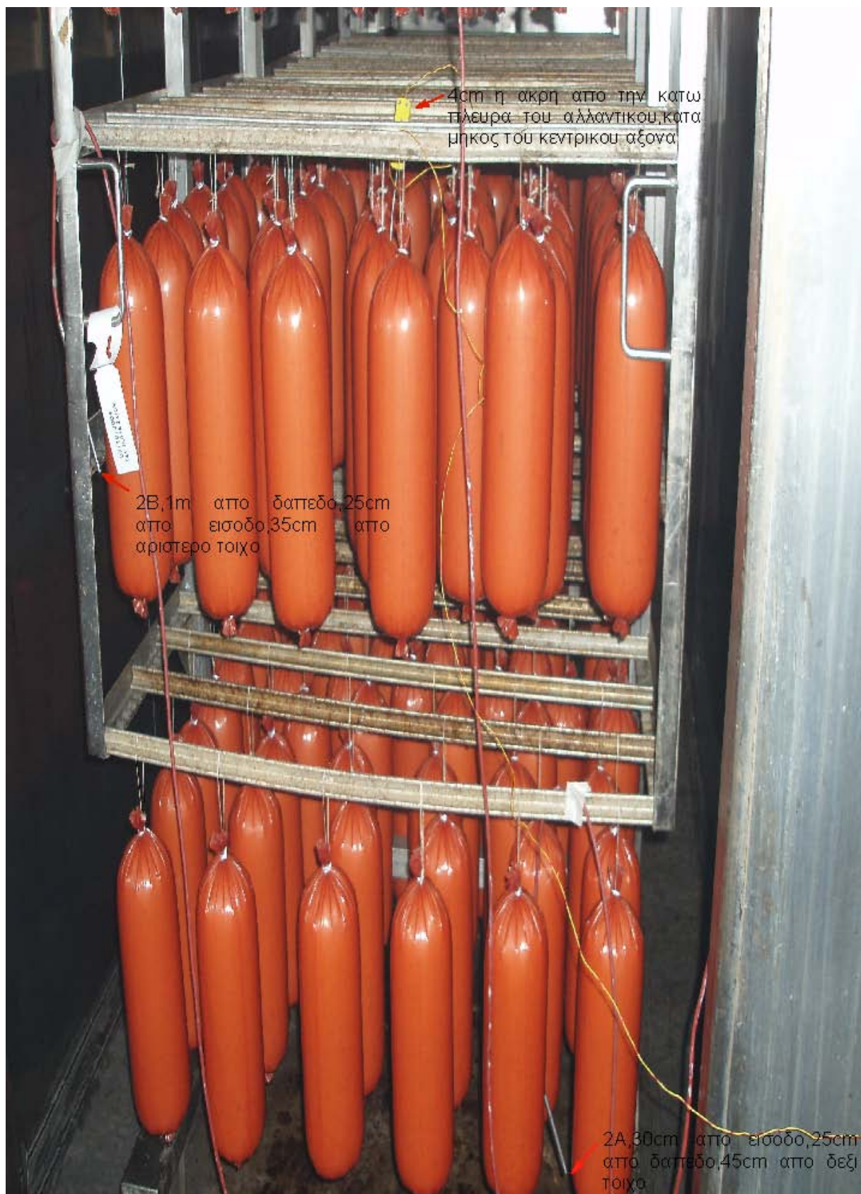
Εικόνα 5. Στην εικόνα παρουσιάζονται τα σημεία όπου τοποθετήθηκαν το θερμοζεύγος Κ και τα θερμοστοιχεία 2Α και 2Β,
