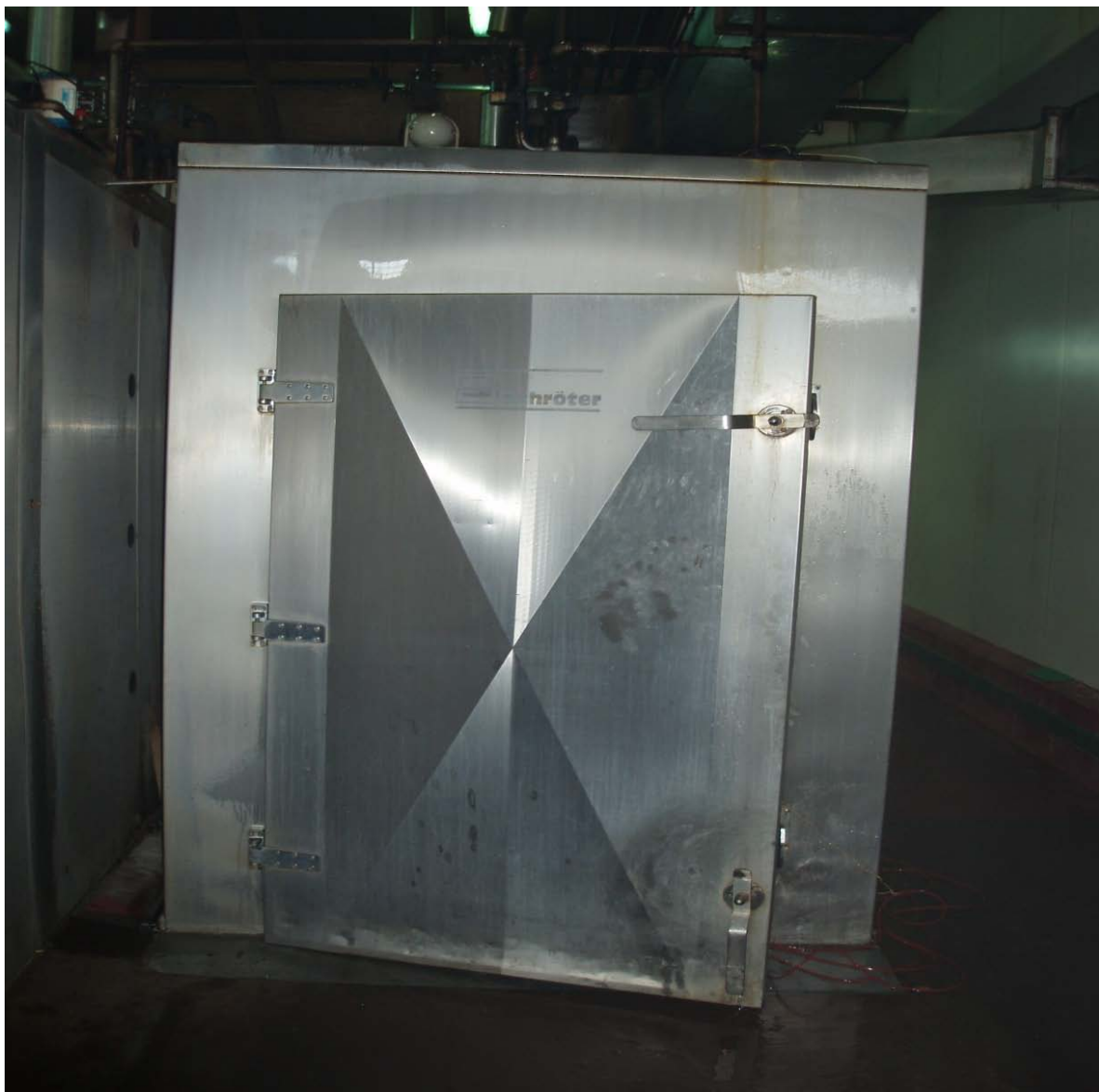
Εικόνα 2. Φωτογραφία βιομηχανικού φούρνου θέρμανσης αλλαντικών
